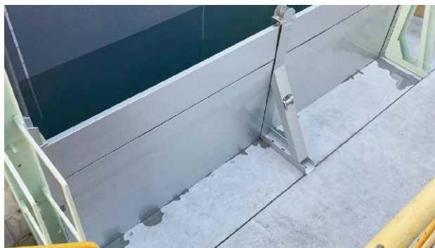
Ws-6仕様の例:40分間かけて水深1mまで抽水した時の漏水の様子
